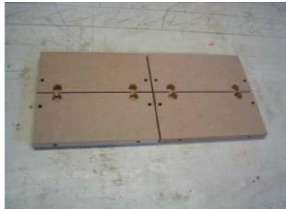
rwobdop.mpr Rückwand oben mit Kabelschlitzen
