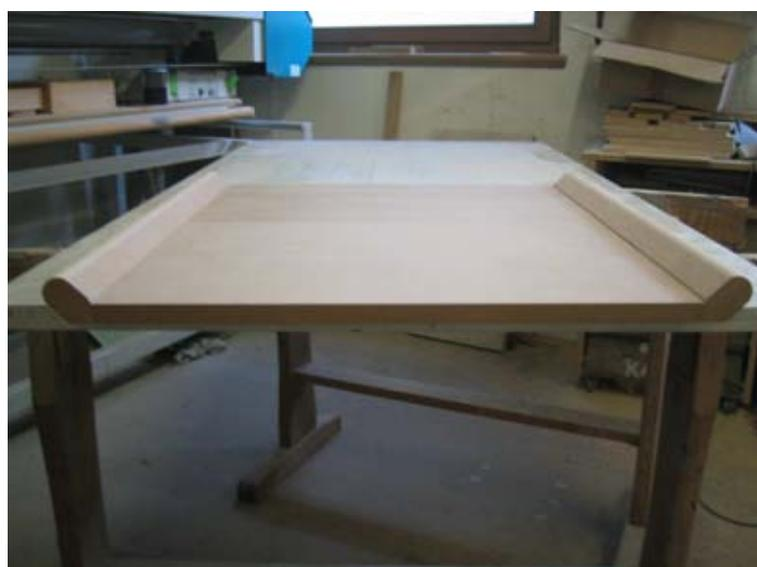
vorgefertigtes Halbzeug, Positionietanschlagkante rechts im Bild
